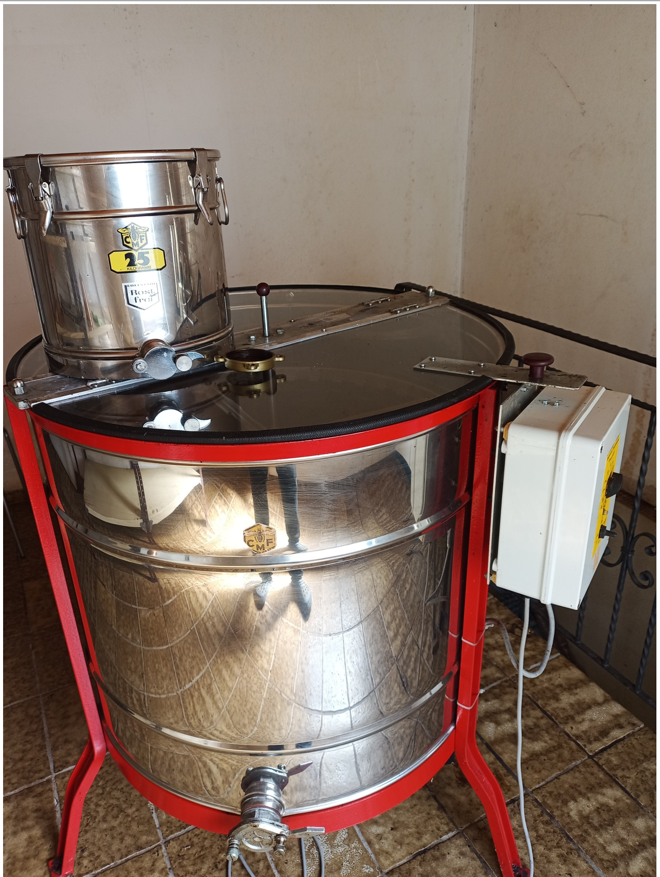
CMF 20 Waben Radial- Wabenschleuder aus Edelstahl
